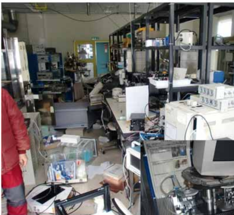
10 接合装置のディスプレイが精密治具 (ウェハ固定ステージ) 上に落下。
