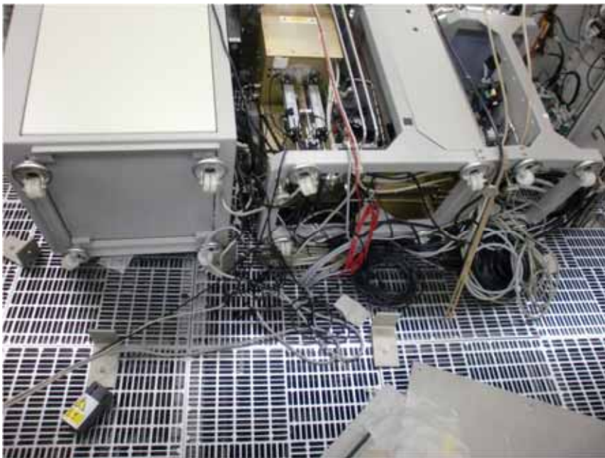
装置にL字金具をねじ留めせず、平行移動防止を図った結果。
