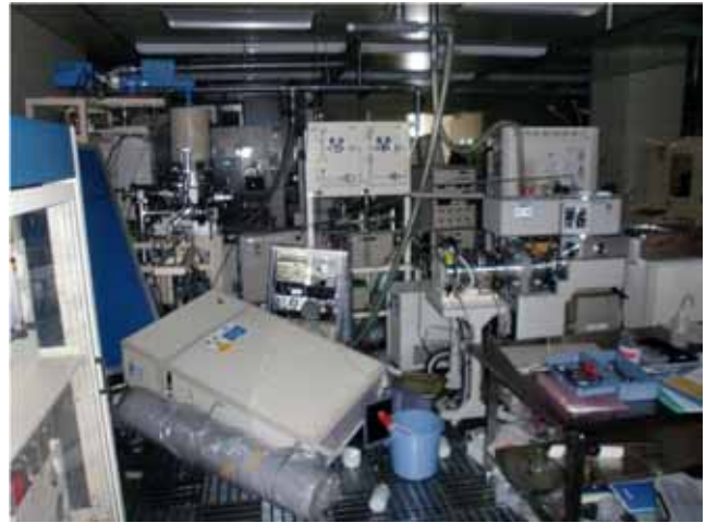
周辺装置が横倒しになり、真空ポンプや真空配管が破損した別のDRIE装置
